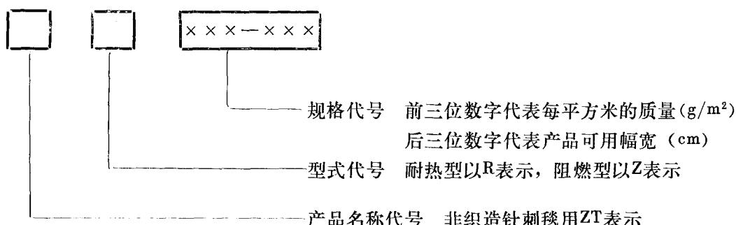
如：ZTZ400-150表示平方米质量为400 $\text{g}/\text{m}^2$ ，可用幅宽为150cm，用作电热毯的阻燃型的非织造针刺毯。
